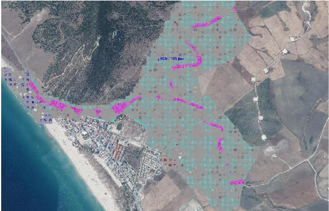
Malla de triángulos para el modelo hidráulico en IBER
