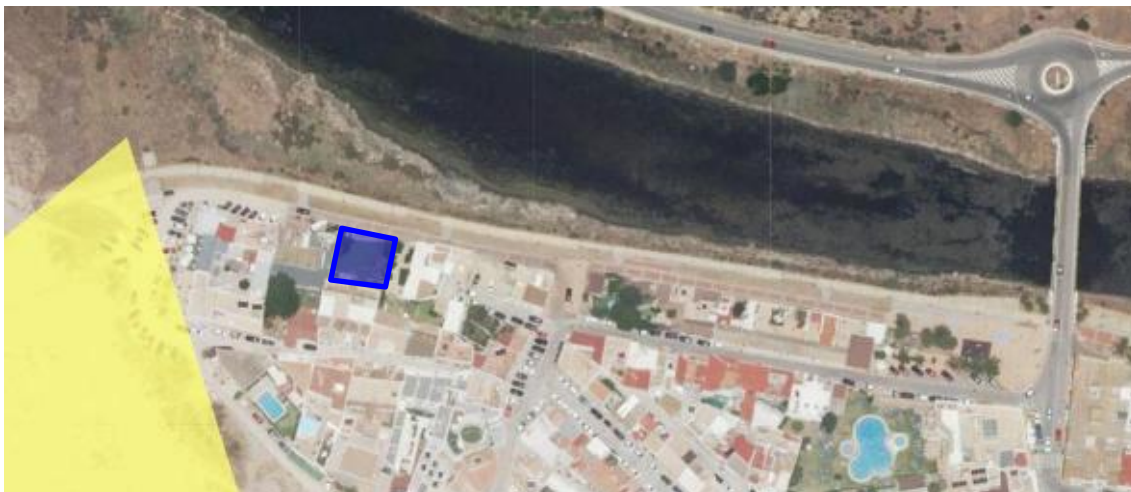
Visor del SNCZI: Zonas Inundables de origen marino con probabilidad baja o excepcional (T=500 años)
