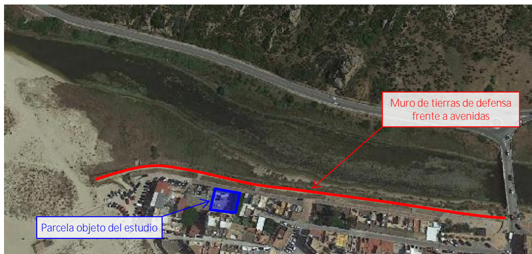
Situación de la parcela y alineación del muro de tierras de protección frente a las crecidas del río
